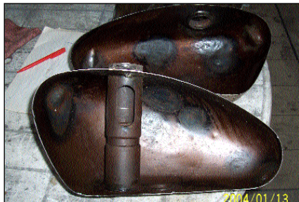
A tank mindkét felébe benzin kerül. Szétbontották a krómozás előtt
