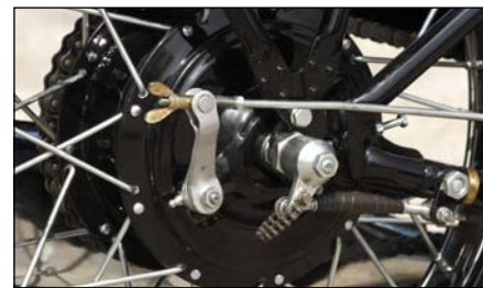
Többlemezes kuplung a hátsó kerék- agyban
