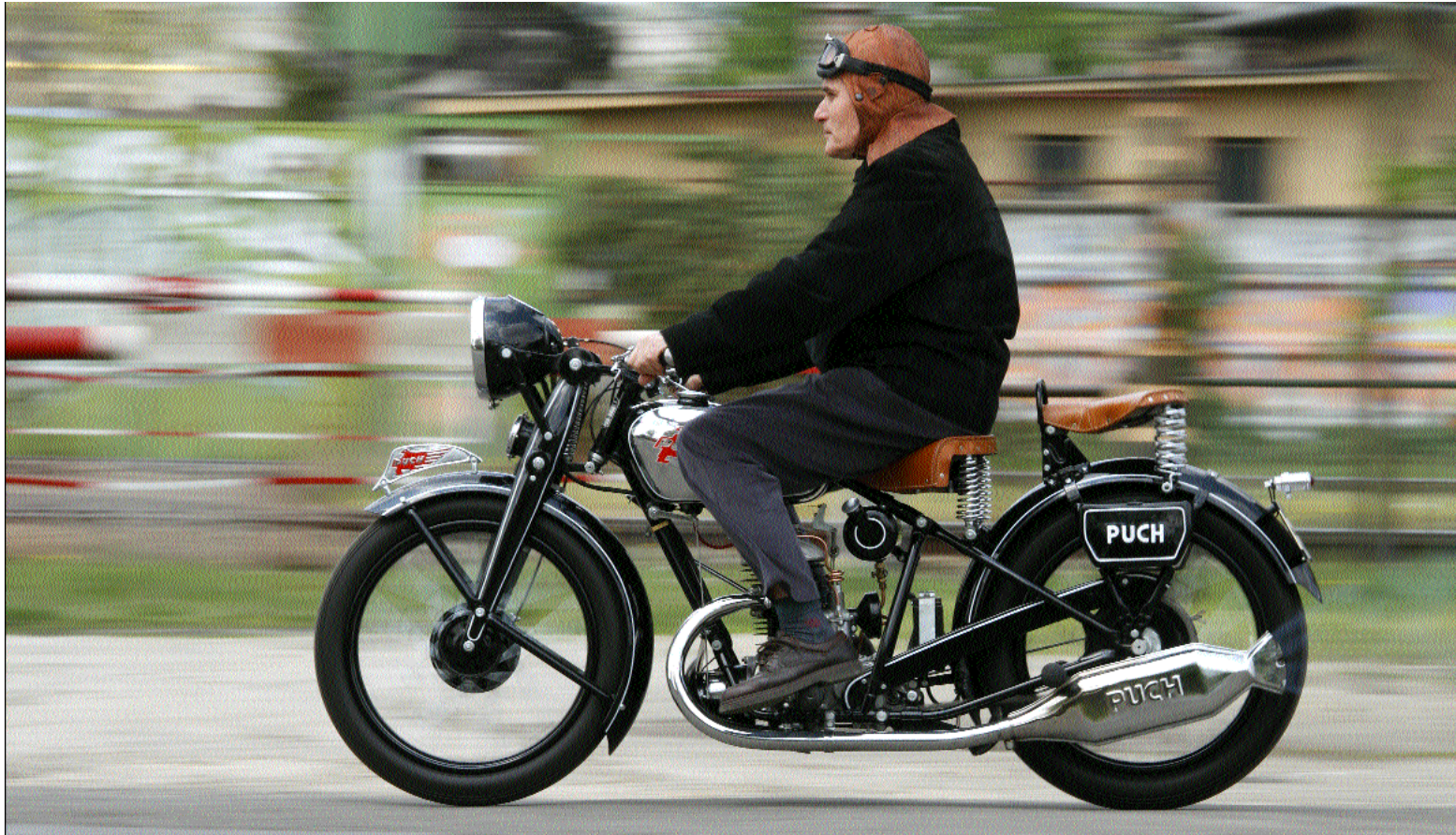
Erős motor, pontos váltó, nyeregrugókra bízott kényelem – meglepően fürge a 10,5 lóerős 250-es.
